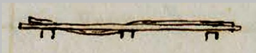
déformation rail double champignon
